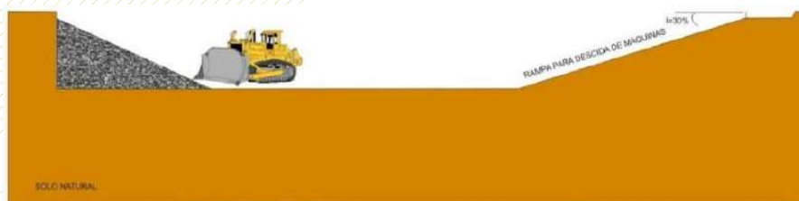
Figura 5.1 – Abertura e compactação da vala. Fonte: Google imagens, 2021
