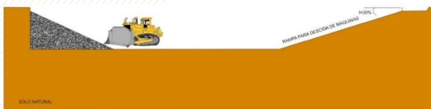
Figura 5.1 – Abertura e compactação da vala. Fonte: Google imagens, 2021
